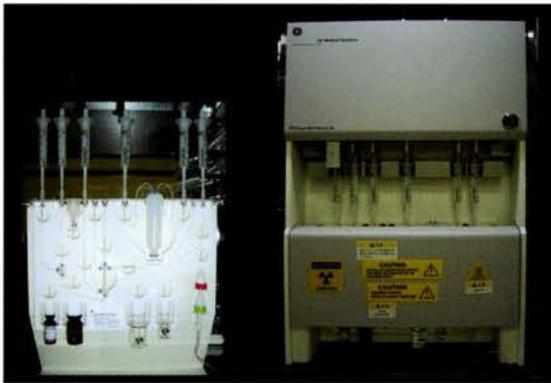
図1. FDG自動合成装置、GE製Microlabとカセット左のディスプレイバイアルに必要薬品を入れ、右の本体にセットする。
