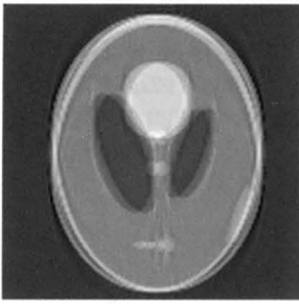
図12 フーリエ変換法において、数値ファントム全体が計測中に読み出し方向であるx方向に動いたときの再構成像。繰り返し時間TR=1000msで、被写体が読み出し方向であるx方向に v_x=0.03\text{cm/s} の速さで位相エンコードの m=10 から -10 までの間動いたときの計測データを元に再構成した画像
