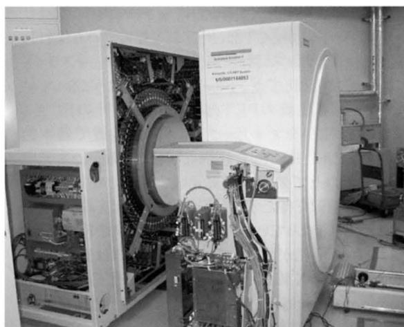
図2 PET-CTのガントリー部。装置のメンテナンス時にはPET部がレール上をスライドして後方に移動してガントリーが分離できるようになっている。PET部はSiemens社のECAT EXACT HR+をマイナーチェンジした装置で3次元収集専用で内部線源を持たない。X線CT部はSiemens社のCT装置 Somatom Emotion Duo相当の装置で2列検出器のスパイラルCTである。
