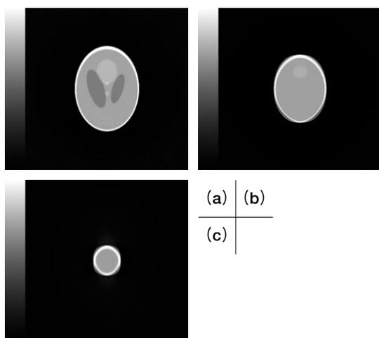
図17. 回転軸であるx軸の値を変化させた場合の $yz$ 平面に平行な断層画像
