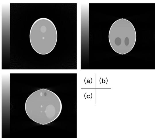
図16. 手順③の重み付けしながら逆投影した再構成画像
