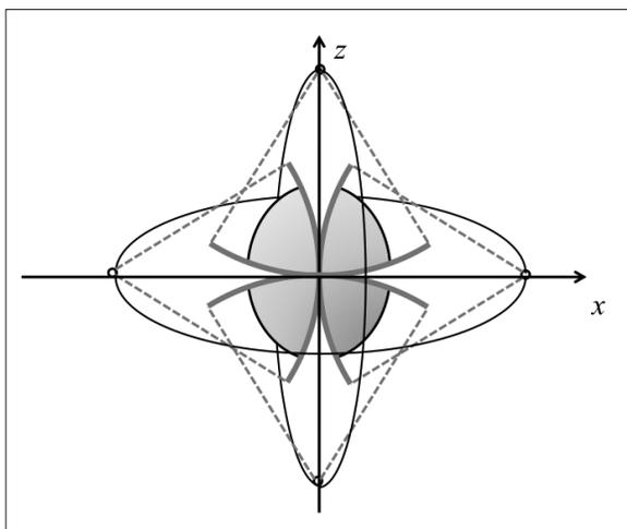
図 20. コーンビームで完全にデータを取得するための方法
